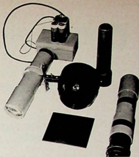
Complete kijker met schijnwerper en telelens en infrarood filter.
